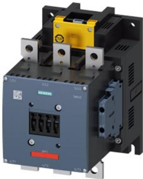
Силовой контактор, AC-3 300 A, 160 кВт/400 В катушка AC 50/60 Гц и DC 96-127 В x (0,8-1,1) вход F-SPS 24 В DC 3-пол., типоразмер S10 вспомогательные контакты 2 NO + 2 NC, несъемные, главная линия: шина, управляющая и вспомогательная цепь: винтовая клемма
