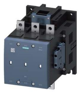
Вакуумный контактор, AC-3 400 A, 200 кВт/400 В AC (50–60  $\Gamma$ ц)/режим работы по DC UC 500–550 В Вспомогательные контакты 2 HO + 2 H3 3-полюсн., типоразмер S12, шинные соединения Привод: стандартный
