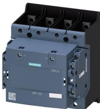
Контактор, AC-1, 200 A/400 В/40 °С, S6, четырехполюсный, 100–250 В AC/DC, 2 НО + 2 НЗ, присоединительная шина/ винтовой зажим
