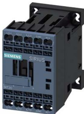
Силовой контактор, AC-3 16 A, 7,5 кВт/400 В 1 НЗ, 24 В DC со встроенным Диод, 3-полюсн., типоразмер S00, пружинная клемма
