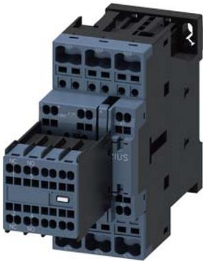
Силовой контактор, AC-3 9 А, 4 кВт/400 В 2 НО + 2 НЗ, 230 В переменного тока 50/60 Гц, 3-полюс., типоразмер S0, пружинная клемма
