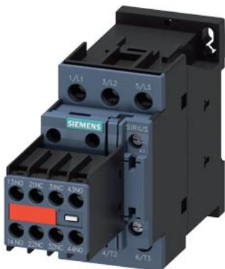
Силовой контактор, AC-3 12 A, 5,5 кВт/400 В 2 НО + 2 НЗ, 230 В AC 50/60 Гц, с установленным варистором, 3-пол., типоразмер S0 винтовая клемма несъемный вспомогательный выключатель
