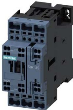
Силовой контактор, AC-3 12 A, 5,5 кВт/400 В 1 HO + 1 H3, AC (50–60 Гц) режим работы по постоянному току 95–130 В AC/DC 3-полюсн., типоразмер S0, пружинная клемма
