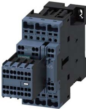
Силовой контактор, AC-3 32 A, 15 кВт/400 В 2 НО + 2 НЗ, 110 В DC 3-полюс., типоразмер S0 пружинная клемма Выключатель вспомогательных цепей, разъемный
