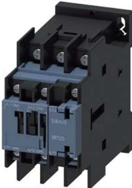
Силовой контактор, AC-3 32 A, 15 кВт/400 В 1 НО + 1 НЗ, 200 В AC, 50 Гц 200–220 В, 60 Гц, 3-полюсн. типоразмер S0 глухой кабельный наконечник
