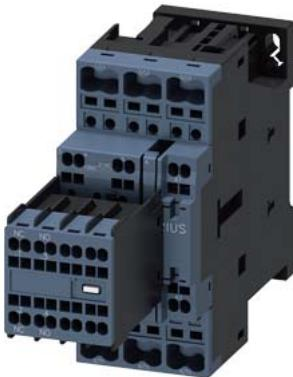
Силовой контактор, AC-3 38 A, 18,5 кВт/400 В 2 НО + 2 НЗ, 220 В AC 50/60 Гц, 3-полюсн. типоразмер S0, пружинная клемма Выключатель вспомогательных цепей, разъемный
