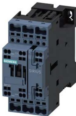
Силовой контактор, AC-3 38 A, 18,5 кВт/400 В 1 НО + 1 НЗ, 125 В DC 3-полюсн., типоразмер S0 пружинная клемма
