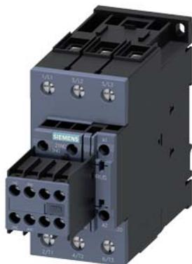
контактор, AC-3 51 A, 22 кВт/ 400 В 2 НО + 2 НЗ, 42 В AC, 50 Гц, 3-пол., типоразмер S2, винтовые клеммы
