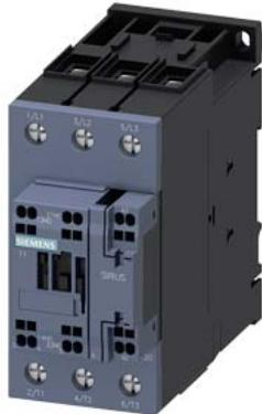
контактор, AC-3 51 A, 22 кВт/ 400 В 1 НО + 1 НЗ, 110 В AC 50/ 60 Гц, 3-пол., типоразмер S2, пружинные клеммы
