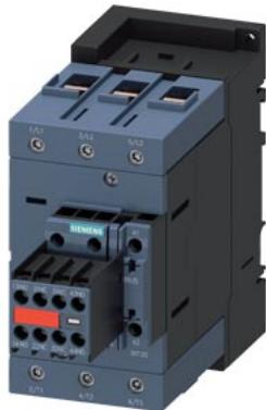
Силовой контактор, AC-3 80 A, 37 кВт/400 В 2 НО + 2 НЗ, 230 В AC/50 Гц 3-полюсн., 3 НО, типоразмер S3 винтовой зажим Варистор установлен выключатель вспомогательных цепей, неразъемный
