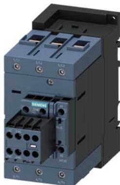
Силовой контактор, AC-3 95 A, 45 кВт/400 В 2 НО + 2 НЗ, 175–280 В AC/DC 3-полюсн., 3 НО, типоразмер S3 винтовой зажим Встроенный варистор
