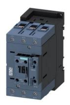
Контактор, AC-1, 160 A/690 B/40 °C, S3, трехполюсный, 220 B AC/50 Гц, 240 B/60 Гц, 1 HO + 1 H3, рамочная клемма/винтовой зажим
