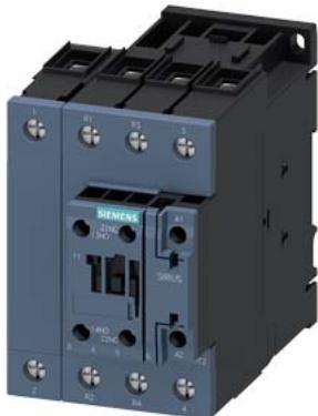
Силовой контактор, AC-3 40 A, 18,5 кВт/400 В 2 НО + 2 НЗ 230 В AC, 50/60 Гц 4-полюсн. типоразмер S2 винтовой зажим 1 НО + 1 НЗ встроены
