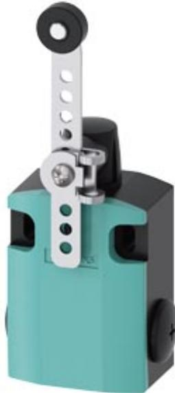
Позиционный выключатель Металлический корпус шириной 56 мм Подключение устройства 3 x (M20 x 1,5) 1 NO/1 HЗ, контакты зависимого действия Поворотный привод регулируется справа/слева, с металлическим рычагом с возможностью изменения длины длина 100 мм, с кинематическим замыканием (отверстие сетки) и пластмассовый ролик 19 мм
