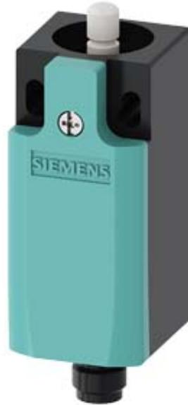
Позиционный выключатель Пластмассовый корпус, 31 мм согласно DIN EN 50047 1 HO/1 H3, контакты зависимого действия со штекером M12, 5-полюсн., фиксир. 2 x светодиод, цвет: желтый/зеленый, 24 В DC Тефлоновый толкатель
