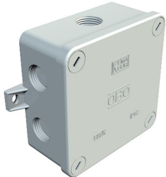
Оценка защиты IP54, пустая коробка для использования с отдельных терминалов, четыре пластиковые крышки болты, таким образом, абсолютная защита от коррозии, два крепления основы болты до Ø 5 мм, 7 секционные элементы с резьбой M20 x 1,5. 3 полиамидные кабельные вводы для кабеля диаметром 9-12 мм, Тип 106 M.
