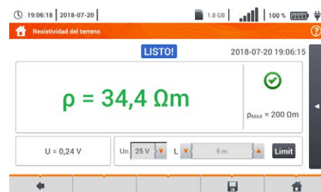
Medición de la resistividad del suelo
